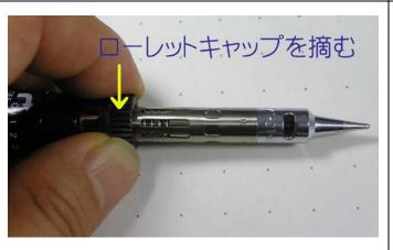
5.着火確認後ローレットから手をはなします 自動的に着火窓は閉じます
