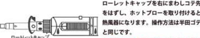
ローレットキャップを右にまわしコテ先をはずし、ホットブローを取り付けると熱風器になります。操作方法は半田ゴテと同じです。
